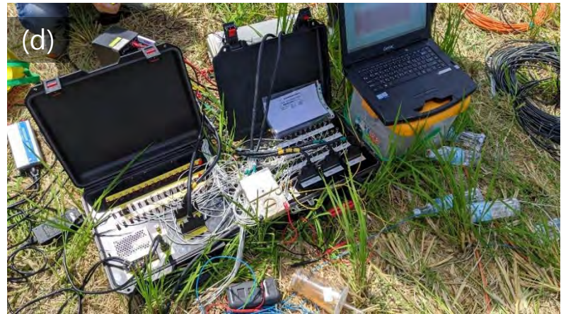
地電阻測勘作業情形
